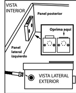
**3** Oprima el botón de desenganche del cable y mientras lo oprime, inserte el cable de seguridad en el hoyo tal como se indica en el diagrama, luego suelte el botón.
